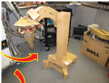
第二代手術機械臂的紙板模型，以便初期測試及改進
