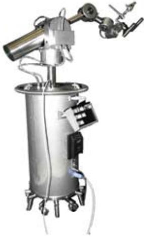
香港中文大學矯形外科及創傷學系開發出首台被動式手術機械人原型系統。該系統已於多項手術中成功應用，取得了良好臨床療效。手術機械人的運用可提升外科醫生操作的精準度。
