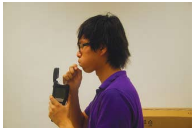
圖三. 研究團隊把微傳感器、壓阻式傳感器、空氣樣本和集成電路系統結合在一起，提供一個便攜式和可用於實地考察的呼吸診斷檢測儀器。
